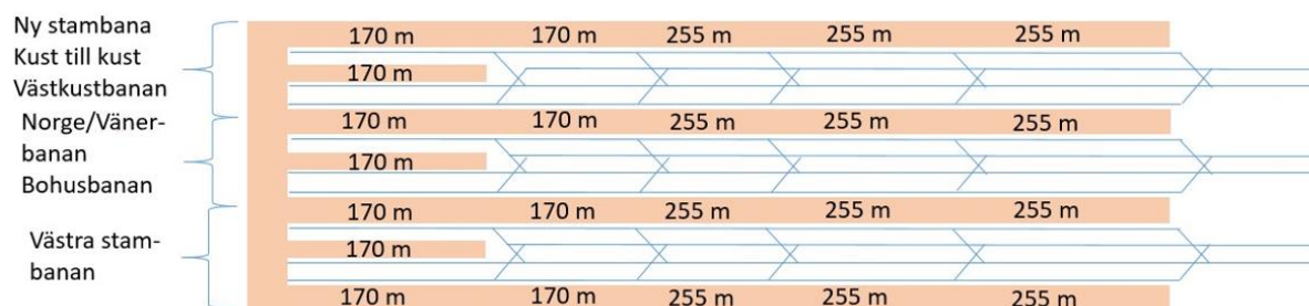
Figur 31 Princip för stationslösning med plattformar på längden.
