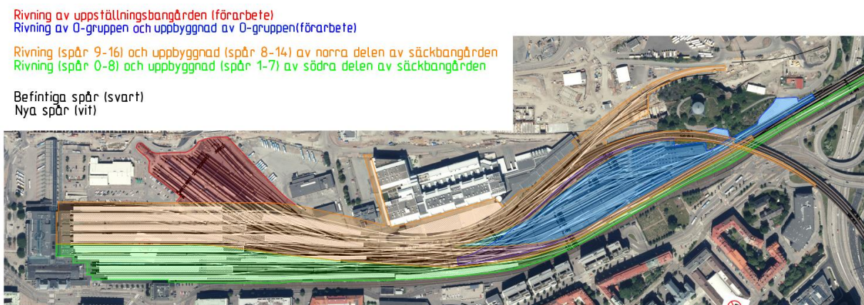
Figur 36 Identifierade etapper för ombyggnad av bangård för två av utbyggnadsförslagen (helavstängning norr + halvavstängning samt halvavstängning norr + halvavstängning söder)
